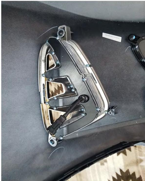
USE WASHERS WHEN PUTTING SCREWS BACK IN SINCE THE BRACKET HOLES WERE WIDENED.
