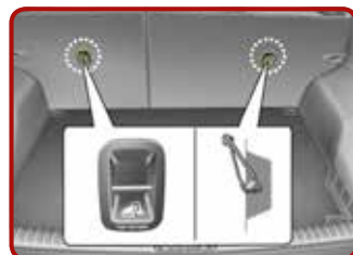
Tvirtinimas naudojant „Tether Anchorage“ sistemą [4]
