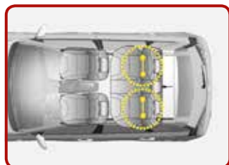
Tvirtinimas naudojant ISOFIX ir „Tether Anchorage“ sistemas [4]
