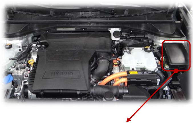
Motorraum-Sicherungskasten
