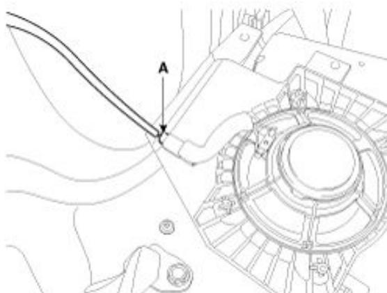
4. Rimuovere l'altoparlante posteriore (A) dopo aver allentato la vite di montaggio.
