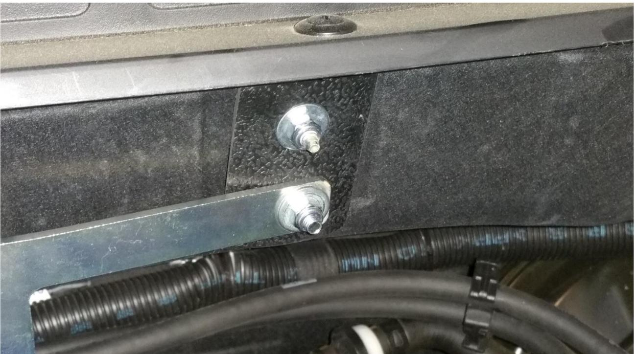
P.S. Se vi viene difficile bloccare con la chiave a brugola la vite inferiore del supporto di gomma per mancanza di spazio, invertite alcuni passaggi, ovvero fissate prima la piastra ai tamponi di gomma e poi i tamponi alla carrozzeria.
