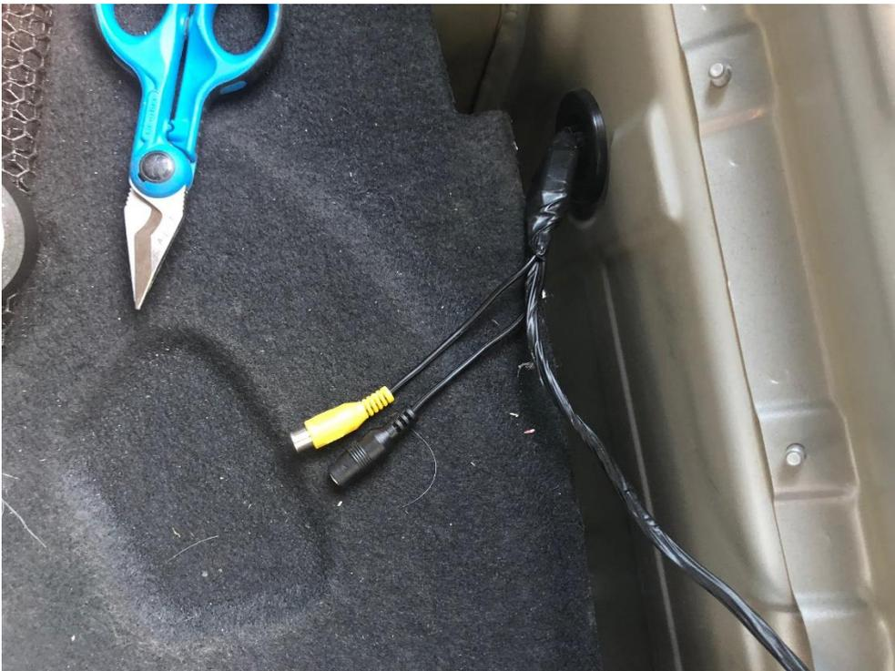
Per l'alimentazione invece ho deciso di prendere il positivo dalle luci di retromarcia in modo che la telecamera si accenda ogni qual volta inseriamo la retro, e la massa dal telaio.
